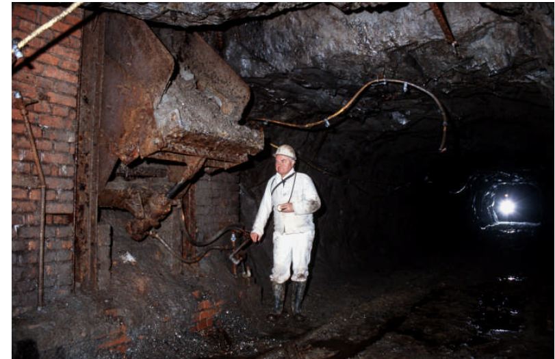
Mit Bergen gefüllter hydraulischer Rollenverschluss auf diesem Niveau
