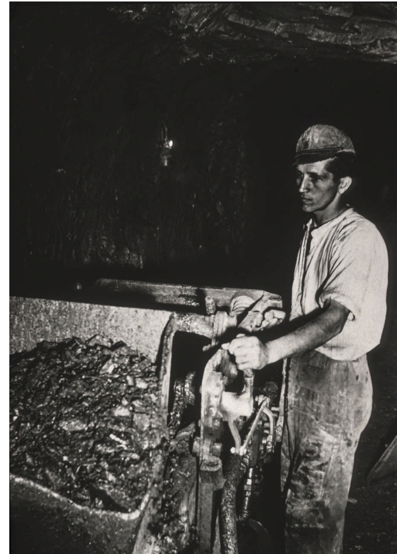
Abb. 6 Hauer vor Ort mit Lademaschine, den ab den 50er Jahren zunehmend in Einsatz gekommenen ersten mechanischen Lade- und Fördergeräten des untertägigen Betriebes
