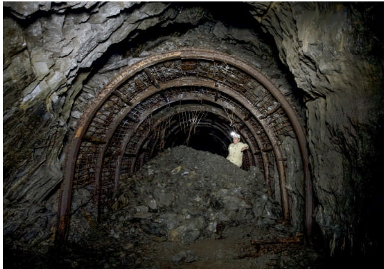
Auf der Sohle des Tiefen Stollens von San Fernando ist offenbar nur kurze Zeit vor der überraschenden Stilllegung noch eine Strecke zur Versatz-Bergeförderung
